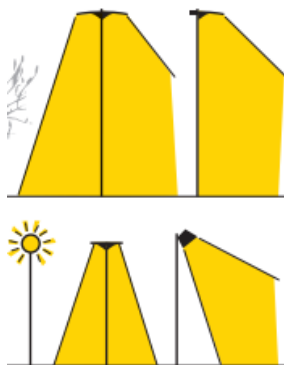
Schéma représentant l'orientation des candélabres [Pays du Mans - Guide de l'éclairage extérieur]
